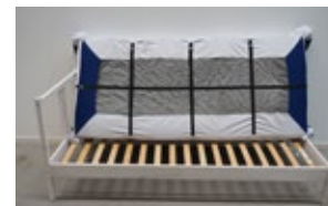
Foto 18: Befestigung der Spanngurte unter der Matratze.
