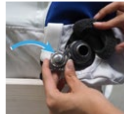
Foto 15: vordere Ventilkappe öffnen
