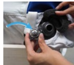
Photo 15: Ouvrir le bouchon de valve avant.
